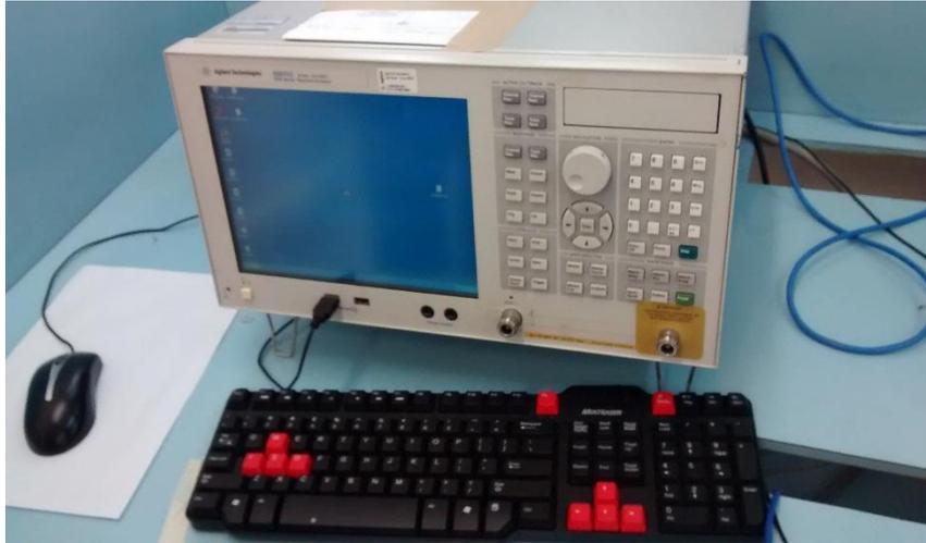
Figura 4.6: Analisador de rede vetorial *Agilent Technologies E5071C*.
